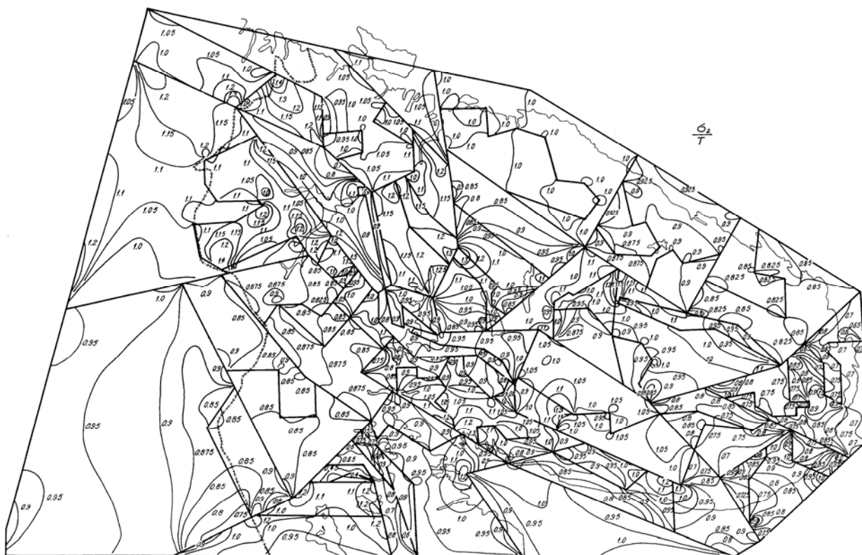
Рис. 7. Распределение главных напряжений в блочных структурах Кольского полуострова
