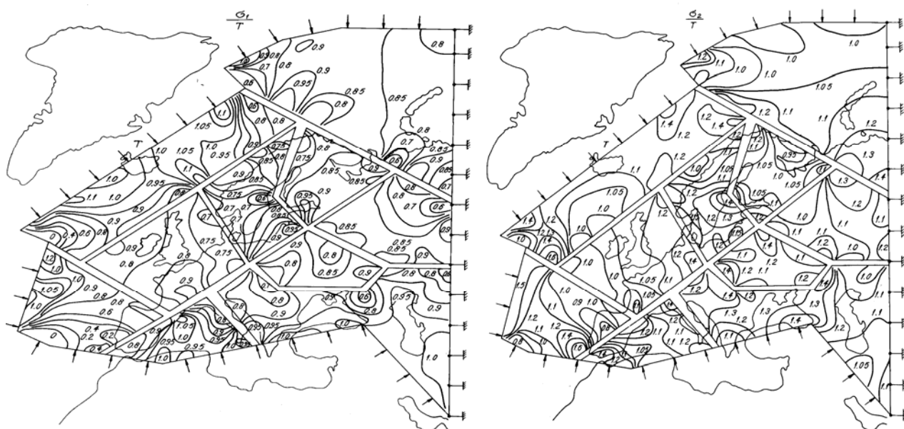
Рис. 4. Схема нагружения и блочного строения Евразийской литосферной плиты и распределение главных напряжений
